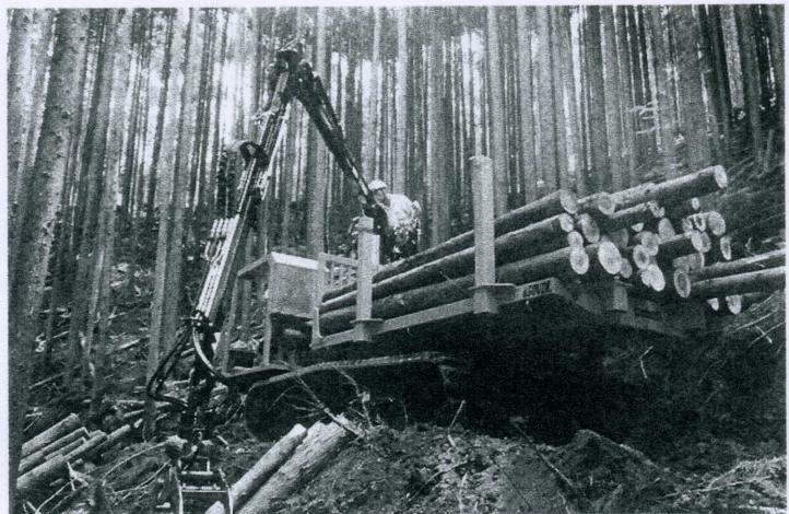
間伐材の積込み
